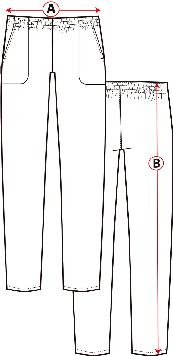
**TOLERANCIA** A- ANCHO (+/- 10 mm) B- LARGO (+/- 10 mm)
